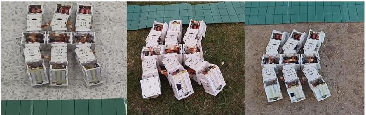
Figura 6-7. Hexápodo Modular MECABOT 4.0 avanzando sobre terreno irregular pasto, rocoso y regular piso del laboratorio.
