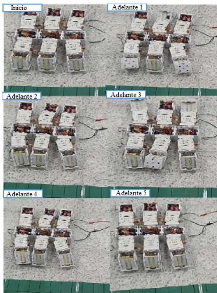
Figura 6-4. Marcha hacia adelante del Robot Hexápodo modular MECABOT 4.0
