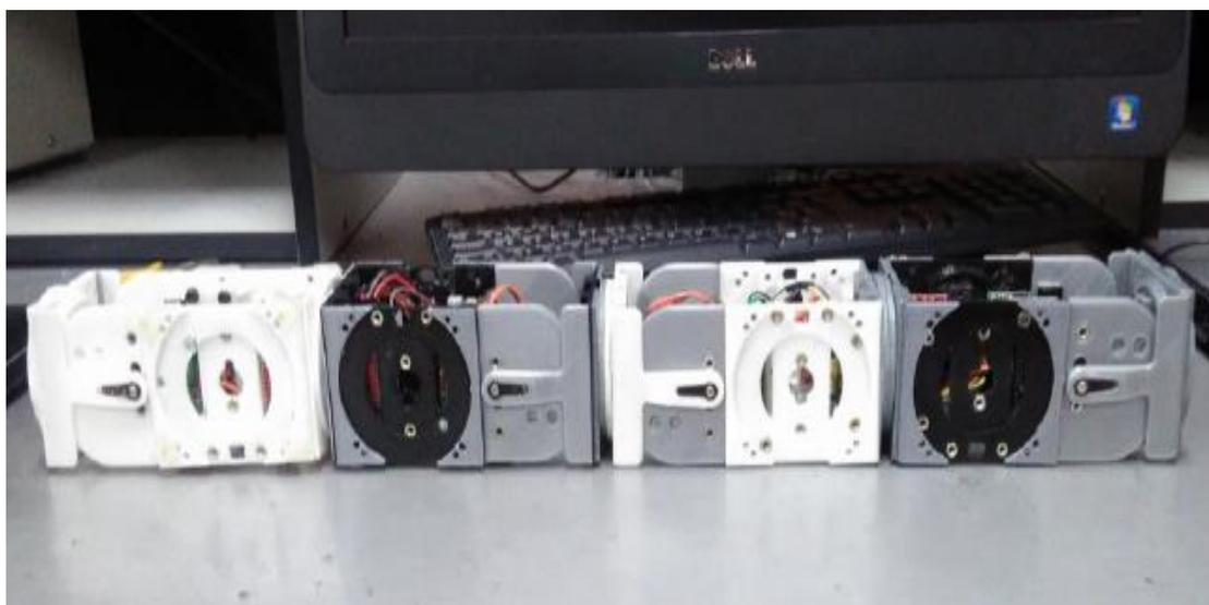
Figura 2-24. Configuración oruga implementada con los módulos MECABOT 3.0
