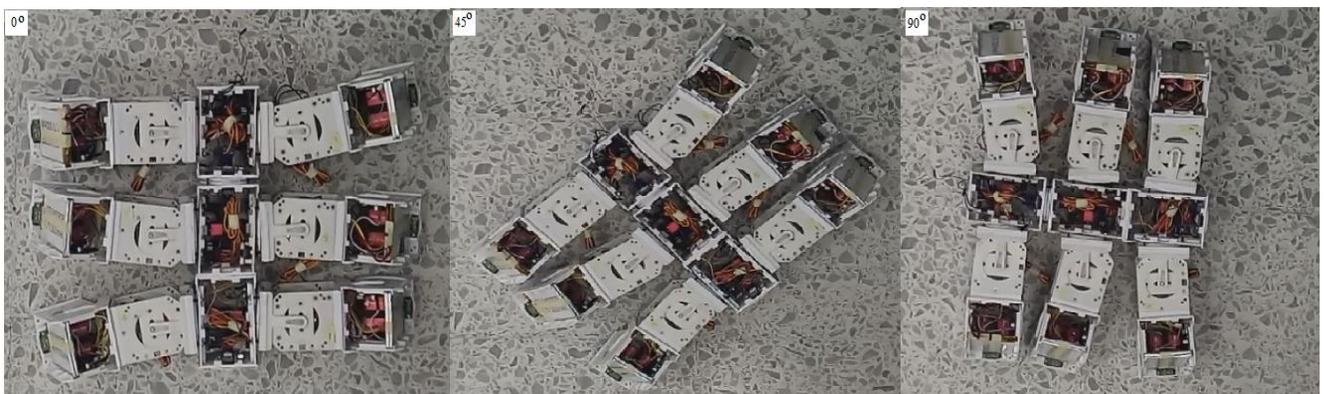
Figura 6-14. Hexápodo modular girando a 45 y 90 grados.
