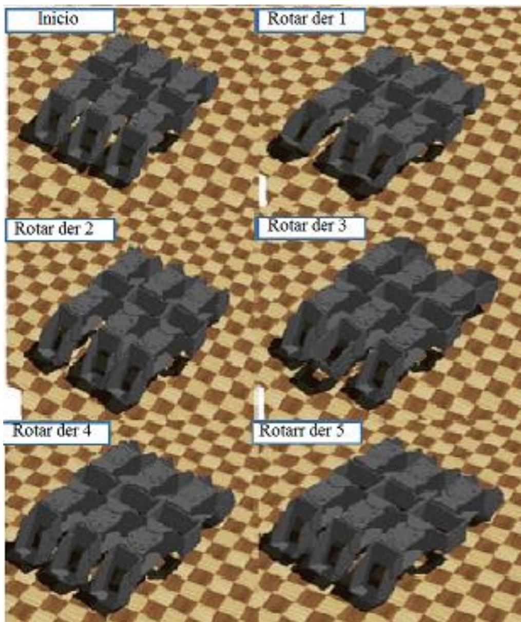
Figura 4-22. Secuencia para movimientos rotacionales hacia la derecha simulada en Webots.
