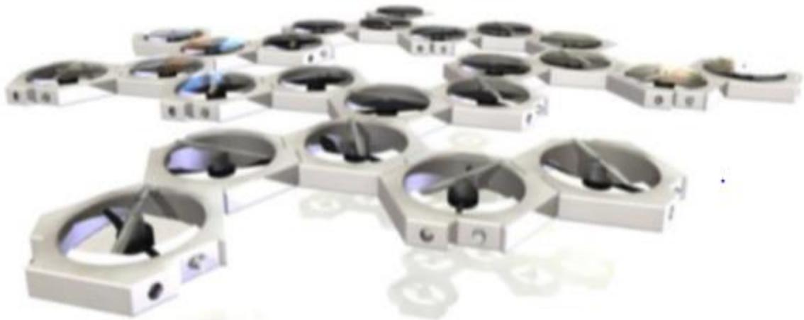
Figura 2-7 Robot modular reticular: Módulos DFA en arquitectura de red
