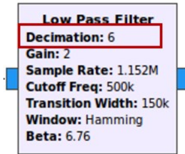
Figura 5.25: Configuración del Filtro PasaAbajo en Gnu-Radio
