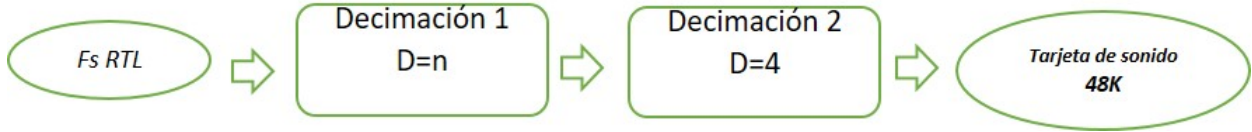
Figura 5.22: Diagrama del flujo de desmuestreo de una tarjeta de sonido
