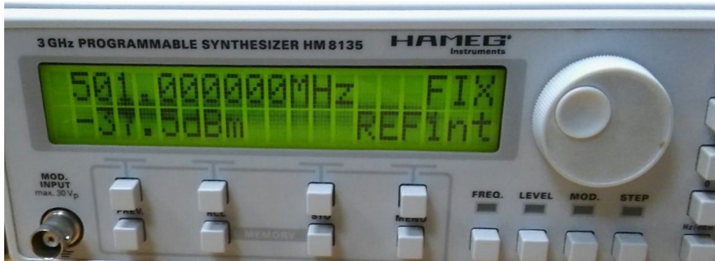
Figura 5.2: Generador de Radio Frecuencia HAMEG. Con Frecuencia de 501MHz y una potencia de -37.5 dBm
