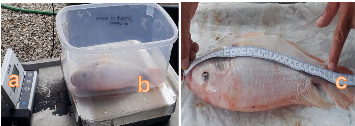
Figura 12. Equipos manejados durante la medición de peces, a: Balanza digital, b: Recipiente plástico, c: Cinta métrica (Santos y Pandales, 2016).
