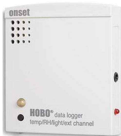
Figura 15. Data logger (Santos y Pandales, 2016).
