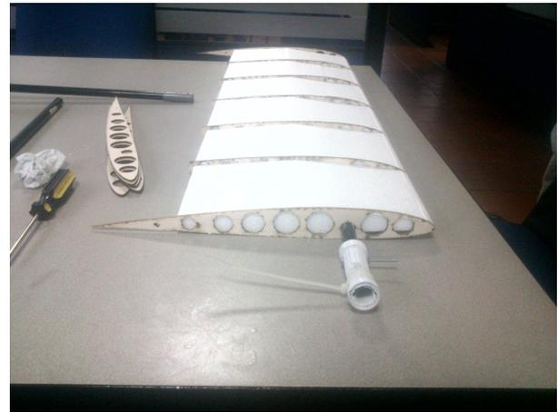
Fig. 11. Construcción del estabilizador horizontal.
