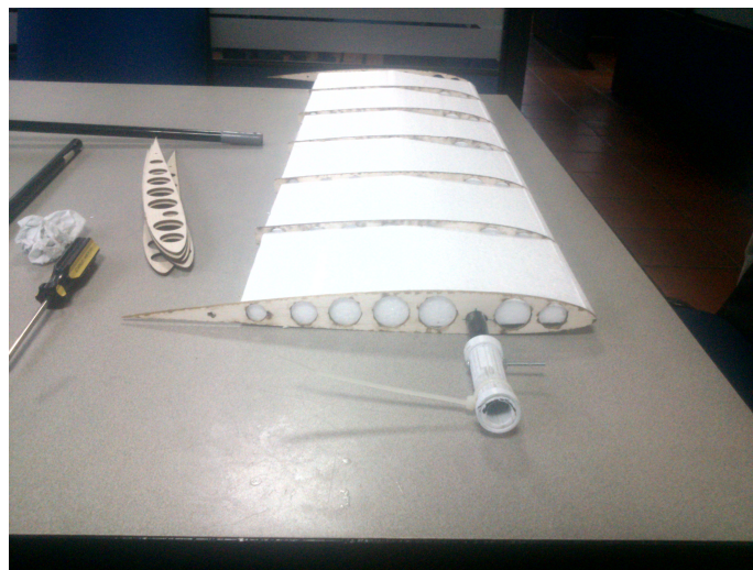
Figura 4-10: Construcción del estabilizador horizontal.
