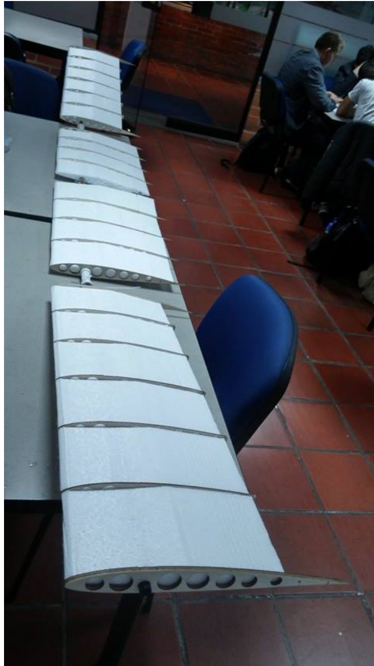
Figura 4-12: Construcción del estabilizador horizontal.
