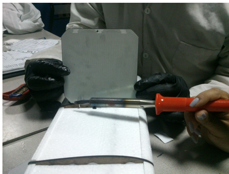
Figura 4-14: Proceso de soldado de las celdas solares.
