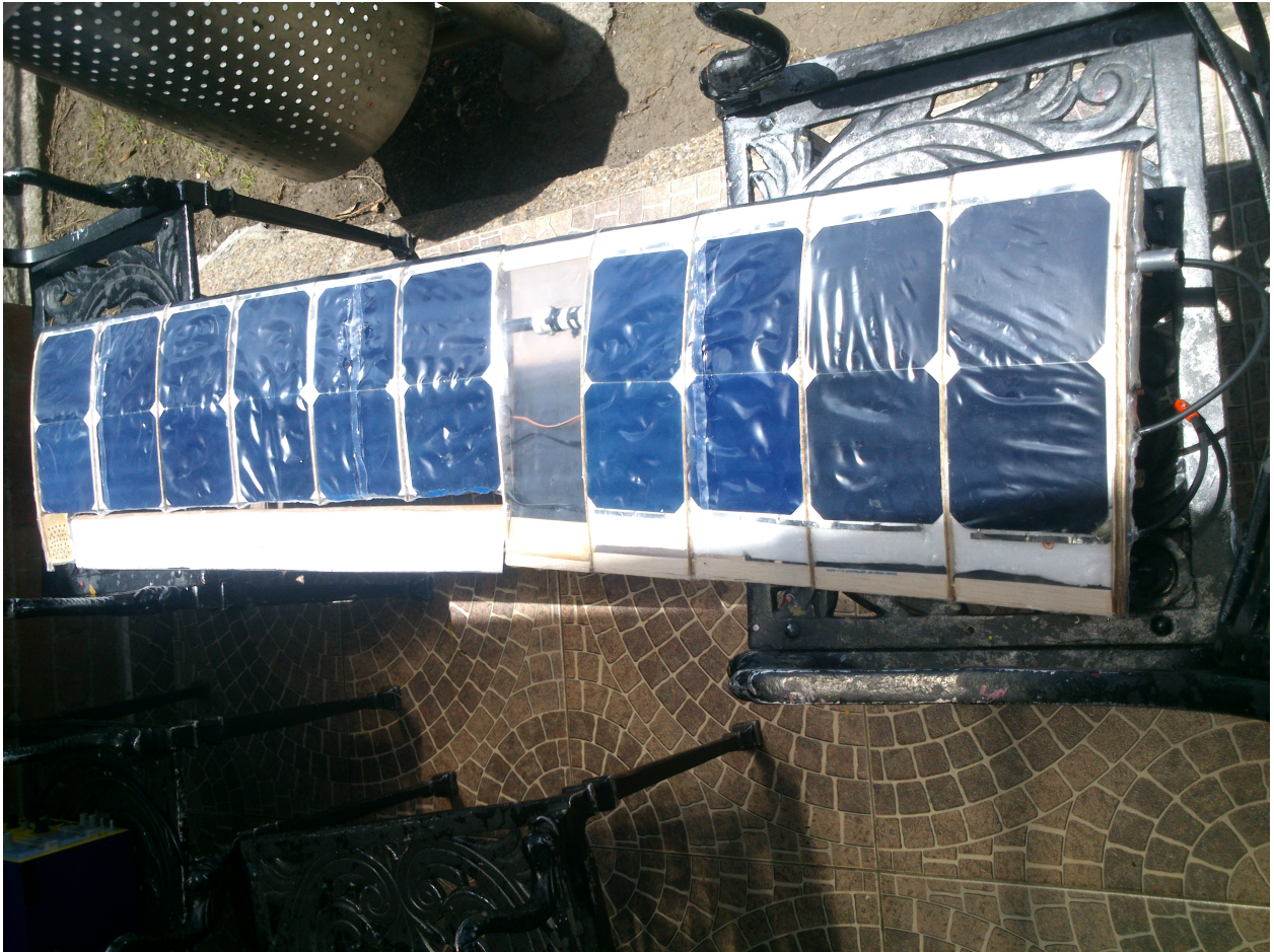
Figura 4-21: Corrección del plastificado de las alas.
