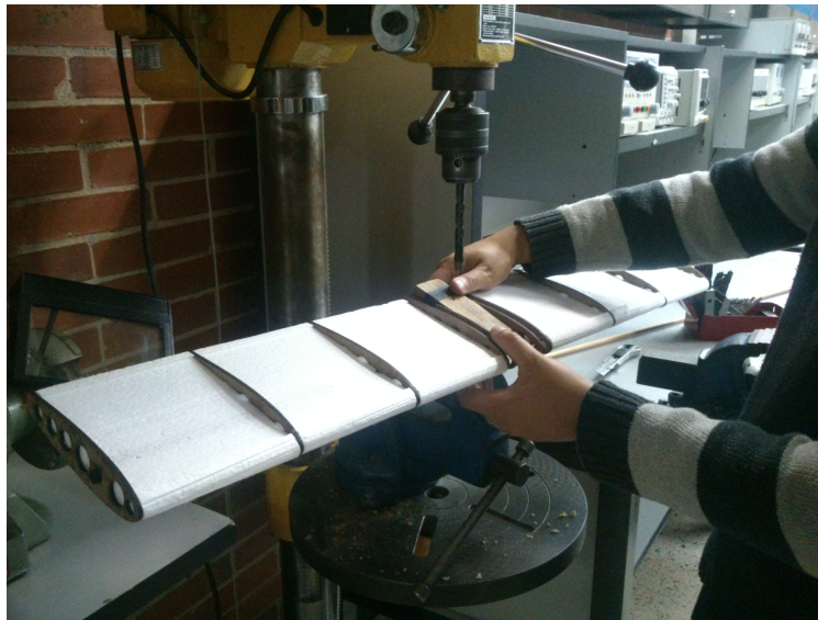
Figura 4-5: Fabricación del estabilizador horizontal.
