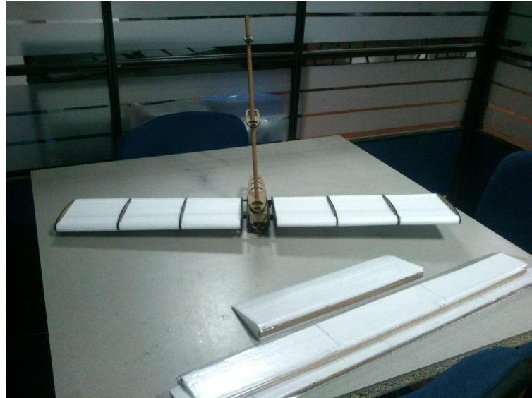
Figura 4-3: Estructura de los estabilizadores y timones de control.
