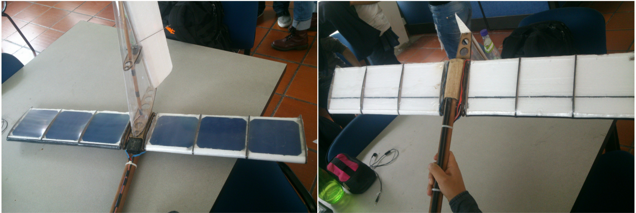
Figura 4-19: Plastificado estabilizador horizontal.
