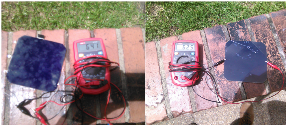
Figura 5-1: Comparación celdas solares con recubrimiento plástico y sin recubrimiento plástico.
