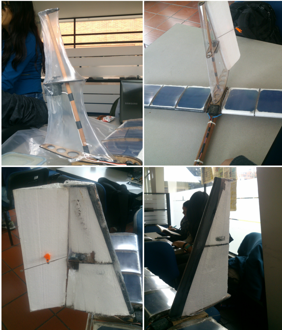
Figura 4-18: Plastificado estabilizador vertical.
