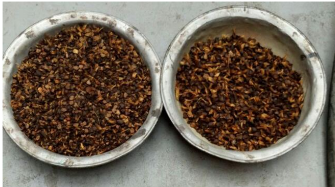
Figura 10. Preparación de muestras para ensayo de degradación en la Maquina de los ángeles. Fuente propia
