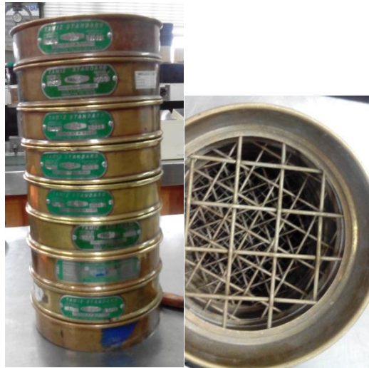
Figura 16. Conjunto de tamices para ensayo de granulometría. Fuente propia
