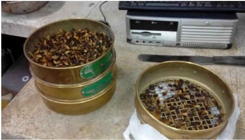
Figura 9. Granluometria de muestras para ensayo de degradación en la Maquina de los ángeles. Fuente Propia
