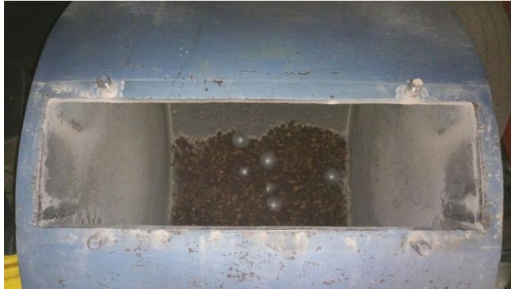
Figura 11 Muestra en la Maquina de los ángeles. Fuente propia
