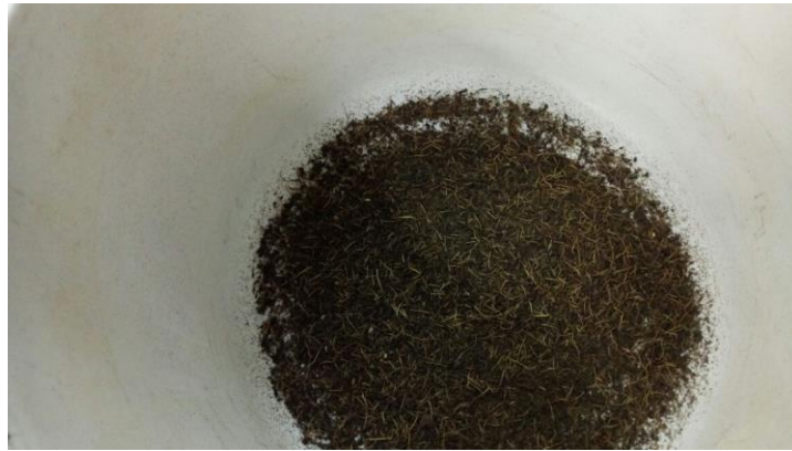
Figura 14. Desprendimiento de material después de degradación. Fuente Propia
