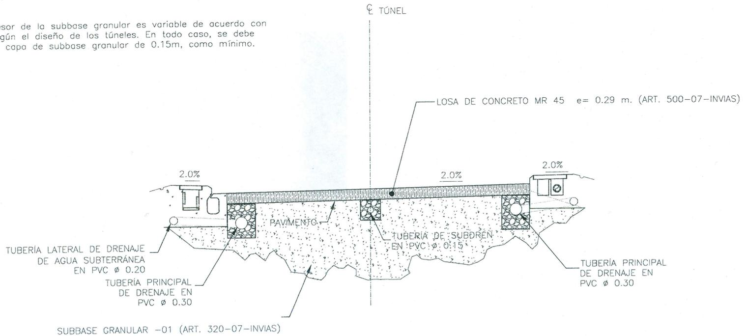
SECCIÓN TÍPICA ESTRUCTURA DE PAVIMENTO TÚNELES KACHOTIS Y PUEBLO NUEVO
