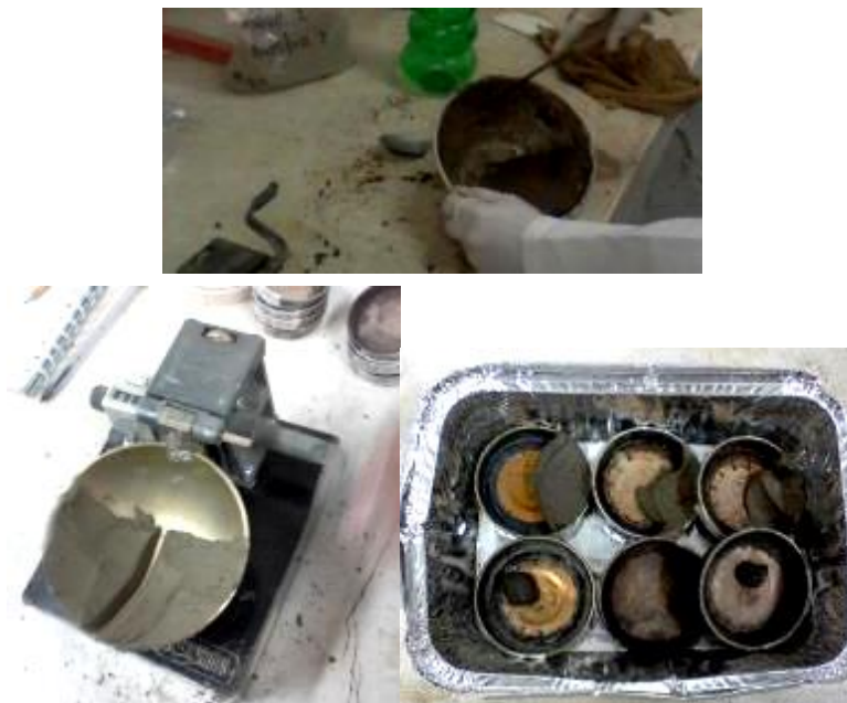
Foto 10. Ensayo para determinar Límite líquido
