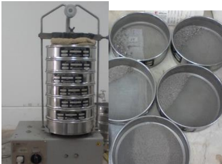
Foto 9. Análisis Granulométrico por Tamizado
