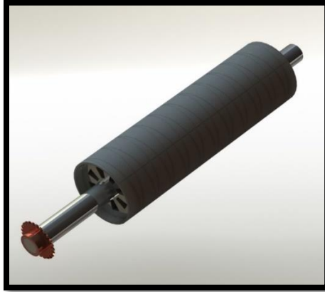
Figura 4.14 Tambor motriz túnel IQF.
