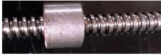
Figura 4.31 Varilla roscada de 5/8 in cuadrada
