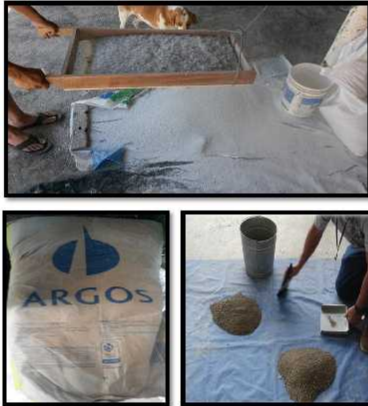
Ilustración 3-2 Materiales empleados para la elaboración del mampuesto
