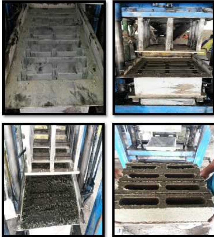
Ilustración 3-4 Elaboración de unidad de mampostería con PET triturado
