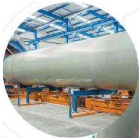
Figura 4. Fabricación tubo GRP. (PAVCO, 2015)
