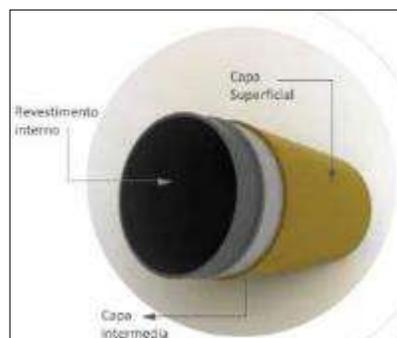
Figura 3. Composición de la pared tubo GRP. (PAVCO, 2015)
