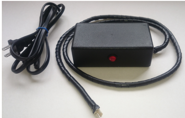
Figura 5.9: Fuente dual de +5v y 5v.
