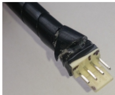
Figura 5.8: Conector molex macho de 4 pines implementado en la fuente de alimentación dual.
