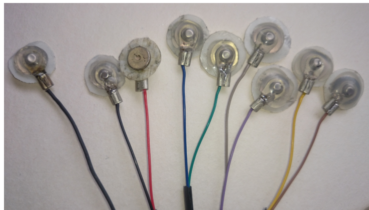
Figura 5.13: Foto de los electodos que actúan como sensores al otro extremo del cable DB-9.
