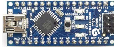
Figura 2.40: Vista superior arduino Nano.
