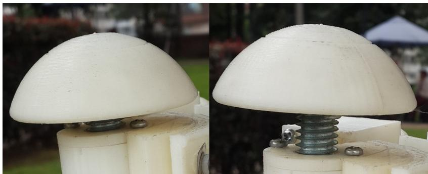
Figura 4.16: Mecanismo ajustable para las manos
