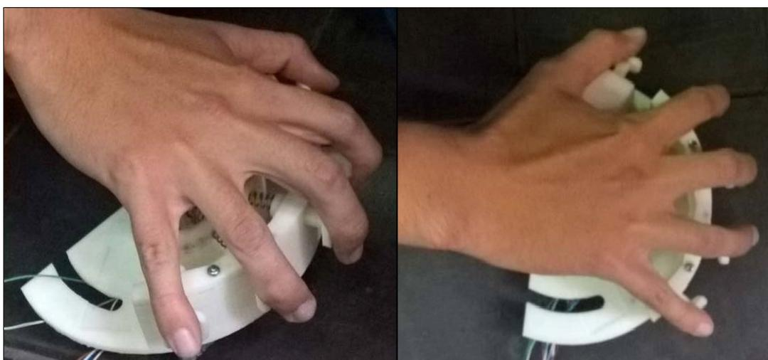
Figura 5.12: Dispositivo medidor de fuerza de los dedos de la mano
