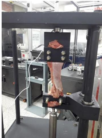
*Figura 47. Montaje del músculo en las mordazas de la máquina de ensayo*
