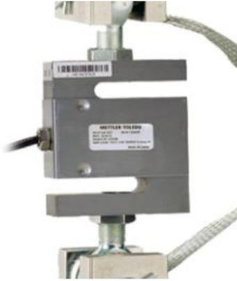
*Figura 10. Celda de carga tipo S [21]*
