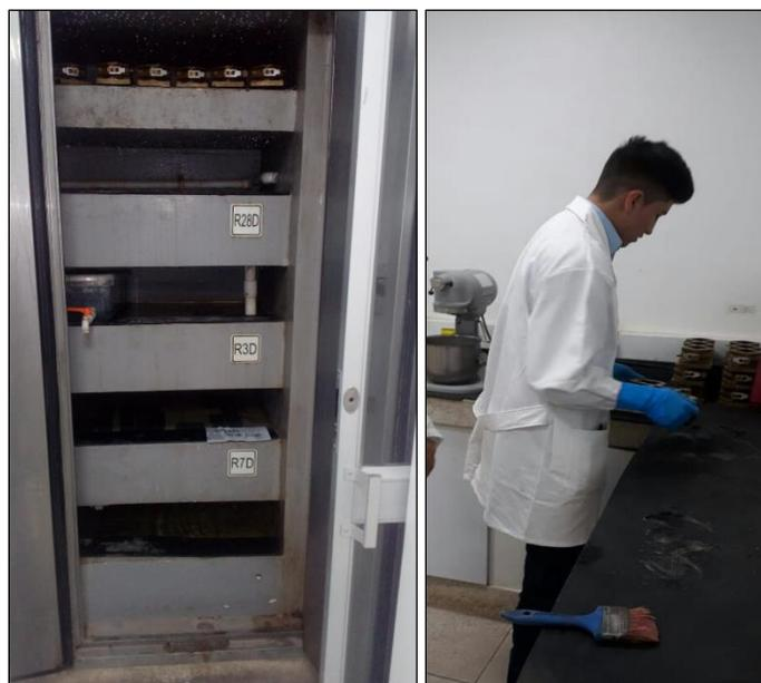
**Figura 1.** Izquierda: Camara de curado. Derecha: Elaboración de morteros por parte del laboratorista
