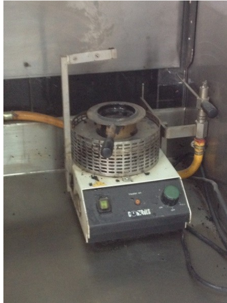
Figura 29. Ensayo Punto de ignición y llama.
