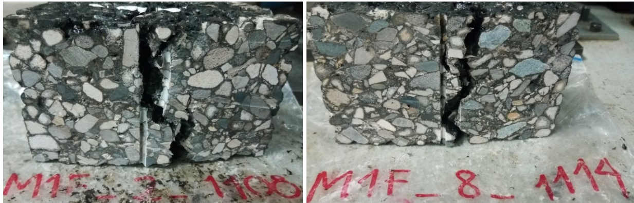
Figura 70 Falla Microaglomerado 1 con fibras Ensayo SCB
