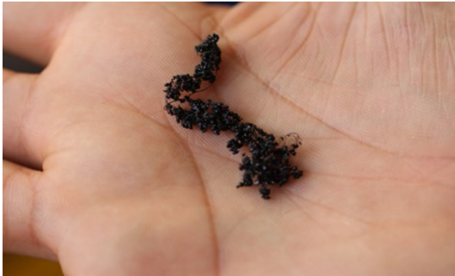
Figura 49 Red Tridimensional Asfalto-Fibra-Agregado pétreo
