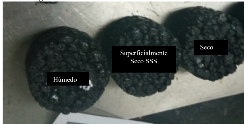
Figura 46 Mezcla drenante en las tres condiciones.
