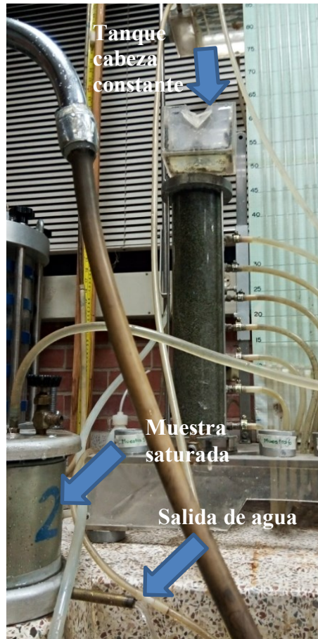
Figura 50 Ensayo de permeabilidad de cabeza constante
