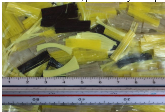
Figura 35. Fibras de aramida, poliolefina y otros polímeros.
