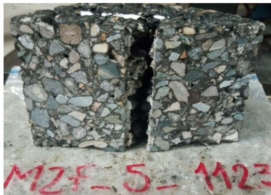
Figura 71 Falla Microaglomerado 2 con fibras Ensayo SCB
