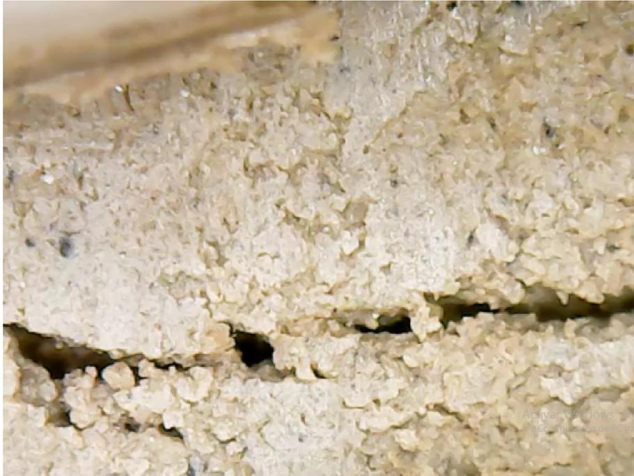
*Figura No 26. Falla muestra arcilla sede U.M.N.G (4°56'40''-74°00'31'') sometida a resistencia a corte. Fuente: Autoría Propia.*
