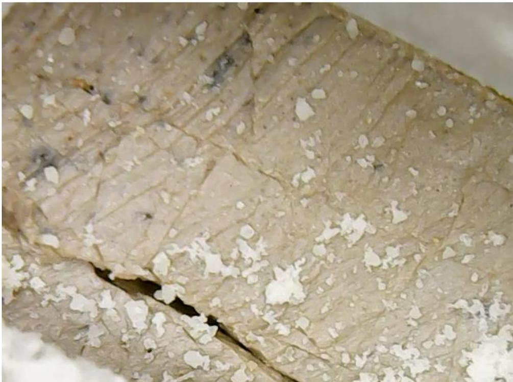
*Figura No 22. Falla muestra arcilla sede U.M.N.G (4°56'30''-74°00'46'') sometida a resistencia al corte. Fuente: Autoría Propia.*
