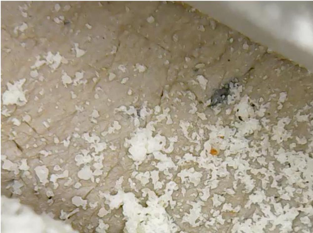
*Figura No 20. Muestra arcilla sede U.M.N.G (4°56'30''-74°00'46'') sometida a resistencia a corte. Fuente: Autoría Propia.*
