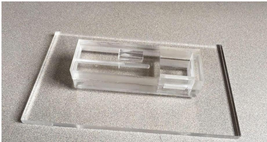
Figura No 11. Molde final Diseño cámara de Corte directo
