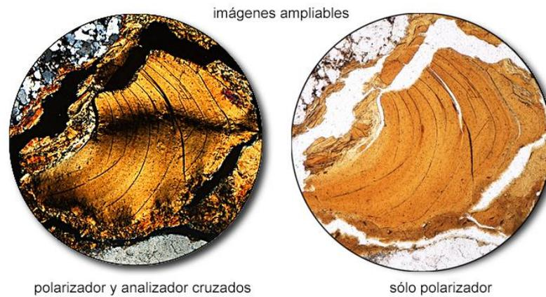
*Figura No 6 .análisis microscópico de arcilla fluvial*
