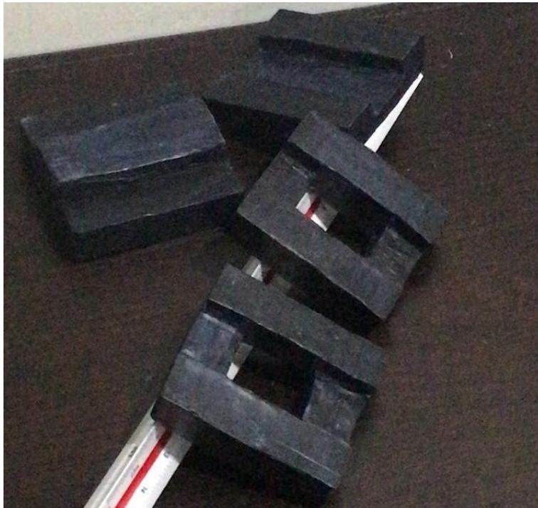
*Ilustración 9: Molde del primer diseño cámara de corte directo*
