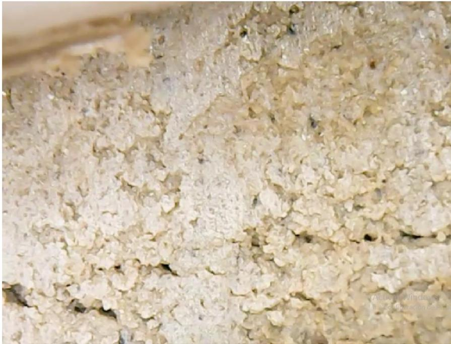
*Figura No 25. Falla muestra arcilla sede U.M.N.G (4°56'40''-74°00'31'') sometida a resistencia a corte. Fuente: Autoría Propia.*
