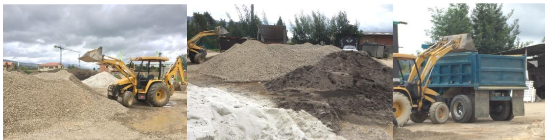
Figura 1. Procesos de la Empresa. De izquierda a derecha, descargue, almacenamiento y cargue de material de construcción en el frente de acopio.
