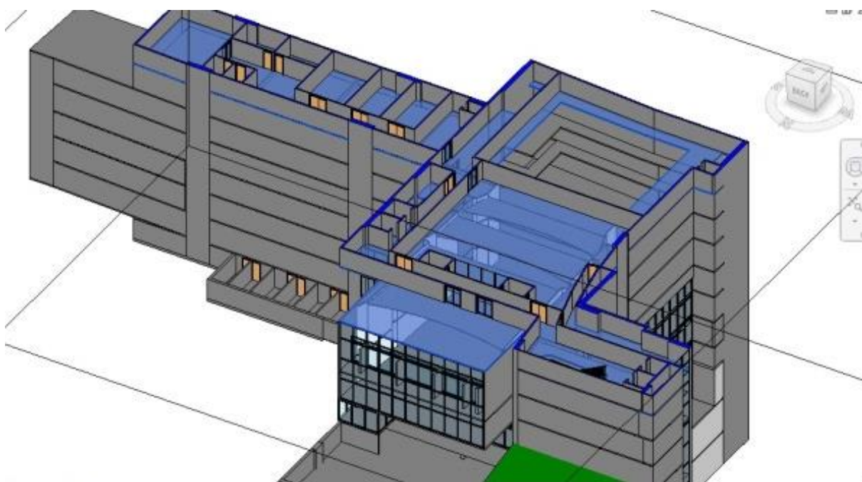
Figura 67. Proceso de modelado puertas y cristales octavo piso
