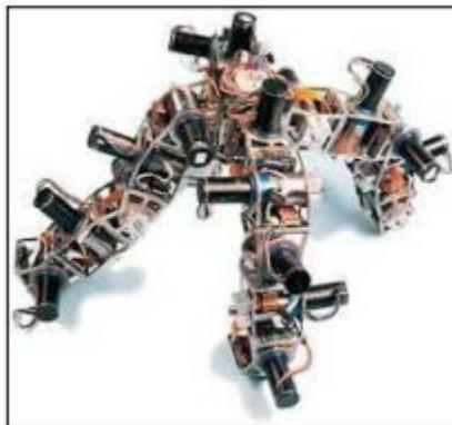
Figura 2.12. Robot Modular PolyBot.
