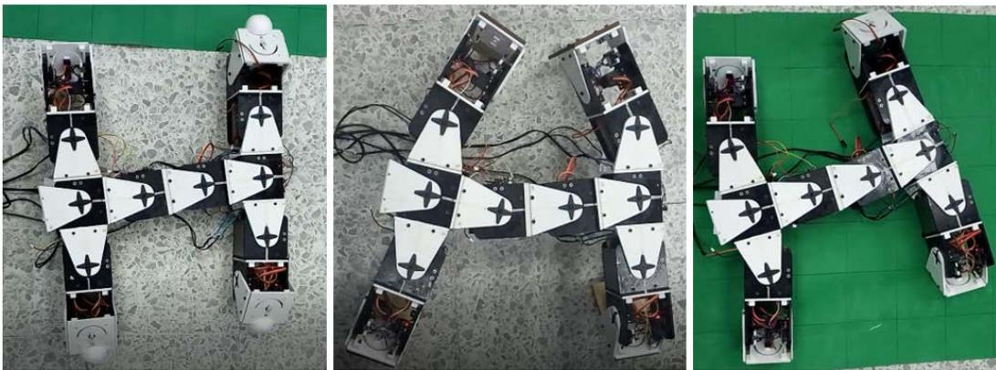
Figura 6.7 Algunas pruebas con aditamentos en el Mecabot 5.0. *Ruedas de Icopor (izquierda), ruedas fijas alargadas (centro) y robot sin aditamento sobre superficie en fomi (derecha). Elaboración Propia.*
