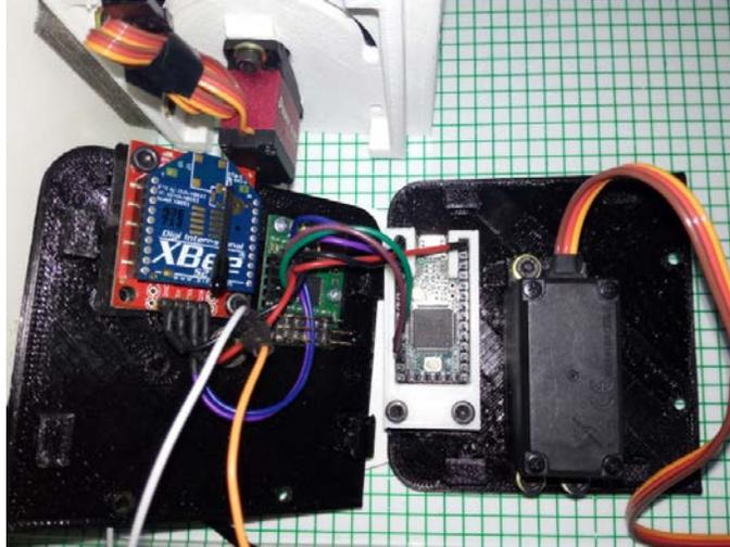
Figura 5.14. Fase de ensamble de elementos electrónicos del Mecabot 5.0.
