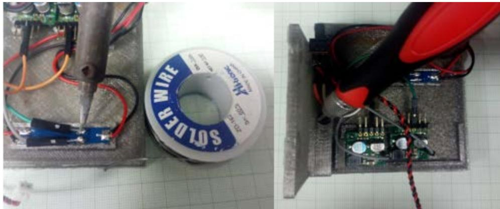
Figura 5.15 Fase de ensamble de elementos electrónicos del Mecabot 5.0.
