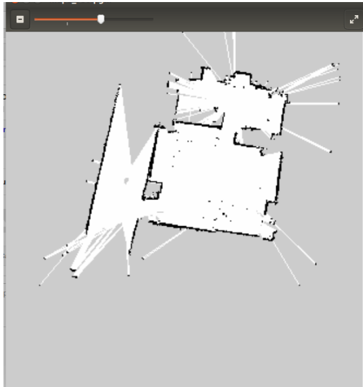
Figura 34 Mapa tomado a velocidad máxima del Pioneer 3DX en Lab de Robótica UMNG. Imagen tomada por el autor
