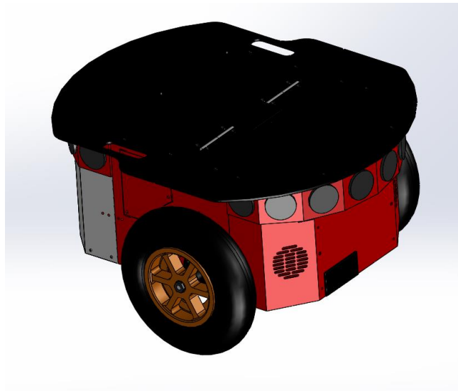
Figura 24 Modelo CAD del Pioneer 3DX. Imagen tomada por el autor
