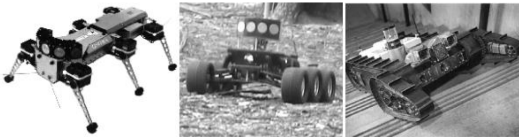
Figura 1 Robots Terrestres: (a) Con patas, (b) con ruedas, (c) con orugas. Imagen tomada de [23]
