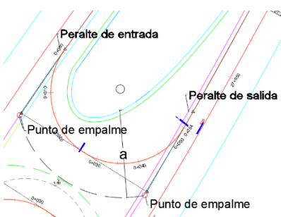
Figura 25: Elementos para el cálculo de la pendiente de la rampa de peralte. Fuente: Autor
