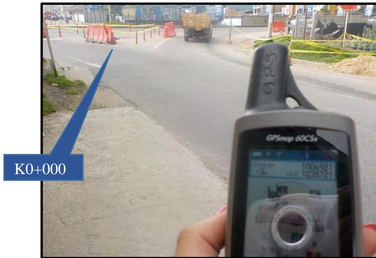
Imagen 2 Coordenadas tomadas y transformación de las mismas de Geográficas a Planas FUENTE: PROPIA
