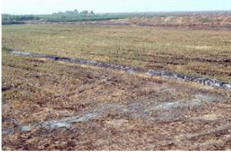
Figura 2.4 a) volcanes de arena a la orilla del río Camaná. b) desplazamientos laterales
