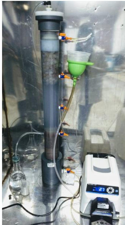
Figura 9. Reactor UASB utilizado. Fuente: Propia
