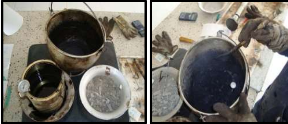
Ilustración 13 . Calentamiento Material Pétreo y Mezcla asfáltica Fuente: Este Estudio
