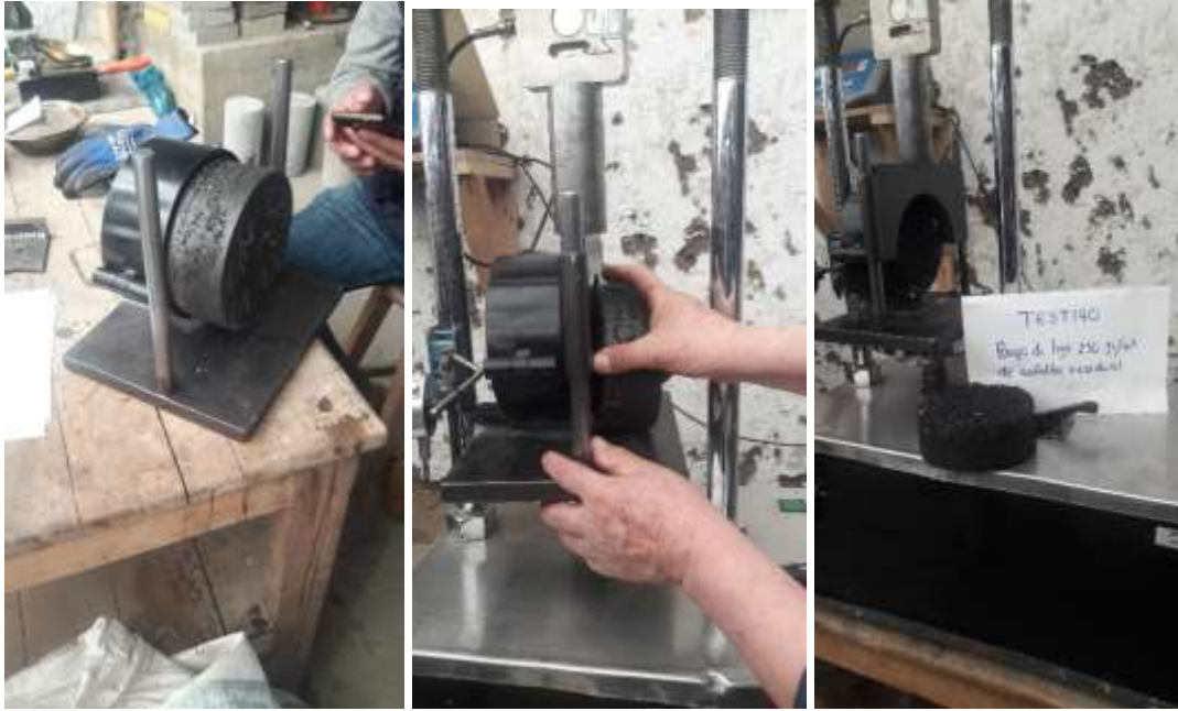
Ilustración 19 Montaje de cuerpo de prueba con dosificación de 250 gr/m 2 de Asfalto residual para realizar el ensayo de Leutner. . Fuente. Este Estudio.
