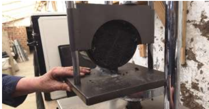
Ilustración 24 Fallamiento de cuerpos de prueba con Ensayo de Leutner, se puede observar geosintético - fiberglass grid fy 137 Fuente. Este Estudio.
