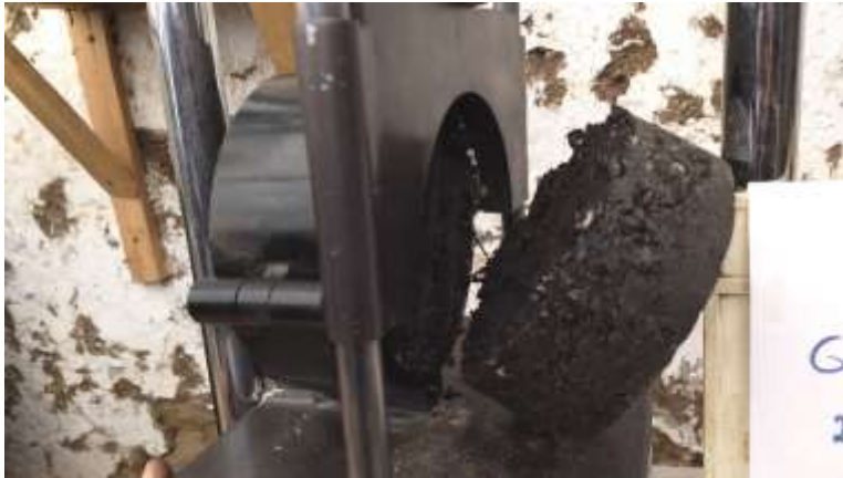
Ilustración 23 Fallamiento de cuerpos de prueba con Ensayo de Leutner, se puede observar geosintético Fuente. Este Estudio.
