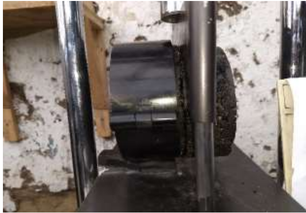
Ilustración 25 . Fallamiento de cuerpos de prueba con Ensayo de Leutner, se puede observar cizallamiento Fuente. Este Estudio.
