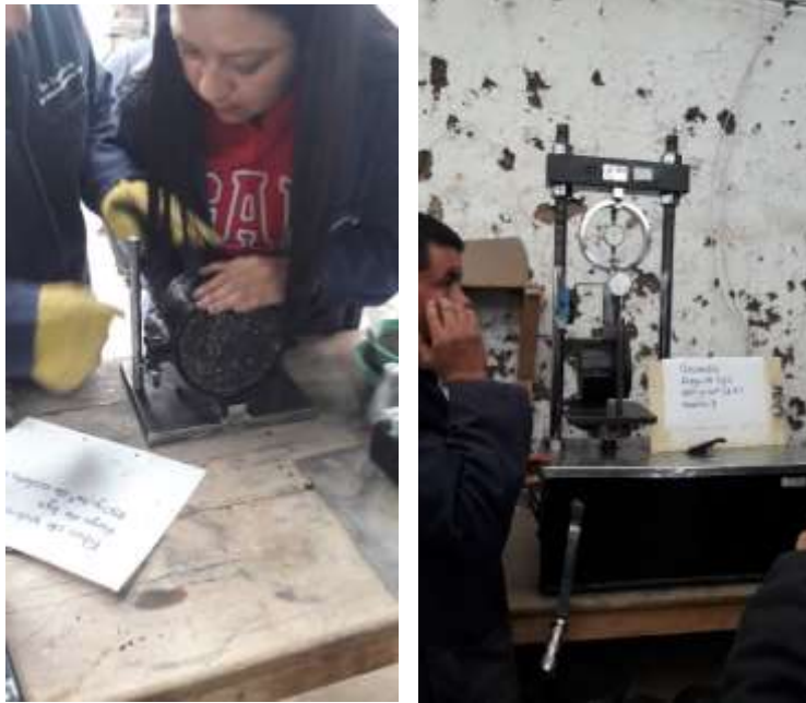
Ilustración 21 Montaje de cuerpo de prueba con dosificación de 550 gr/m 2 de Asfalto residual para realizar el ensayo de Leutner Fuente. Este Estudio.
