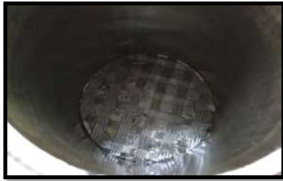
Ilustración 16 Inserción de geosintetico en cuerpos de prueba. Fuente. Este Estudio.
