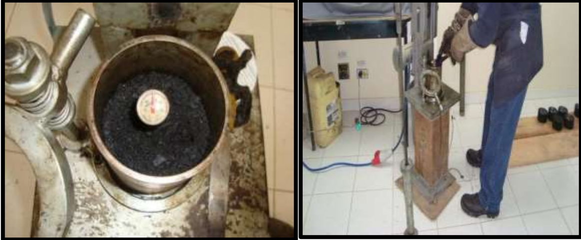
Ilustración 14 Compactación Molde de compactación y Compactación de mezcla asfáltica Fuente Este Estudio
