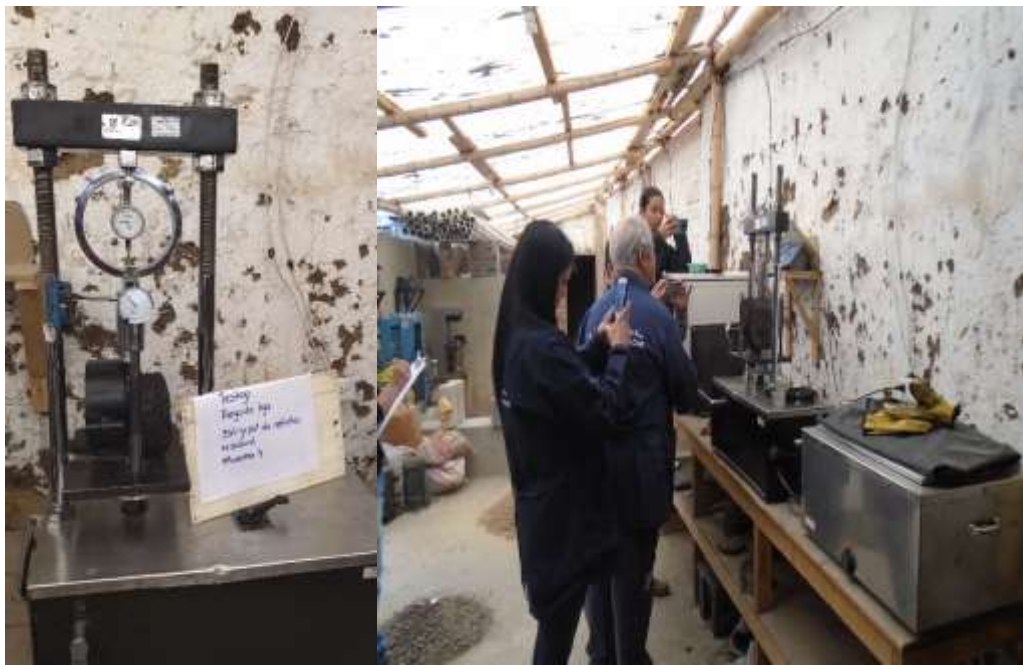
Ilustración 20 Montaje de cuerpo de prueba con dosificación de 350 gr/m 2 de Asfalto residual para realizar el ensayo de Leutner Fuente. Este Estudio.
