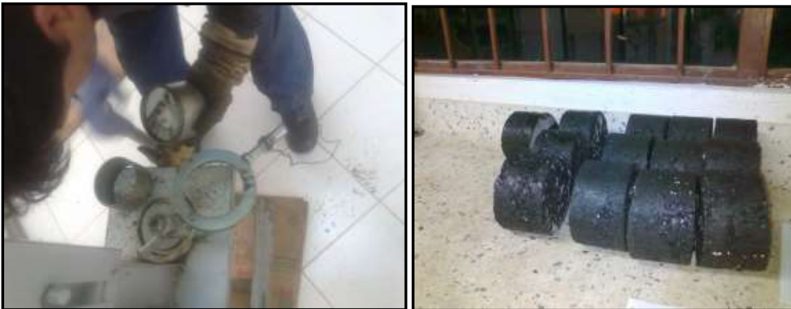
Ilustración 15 Elaboración y desmonte de briquetas Fuente este estudio.
