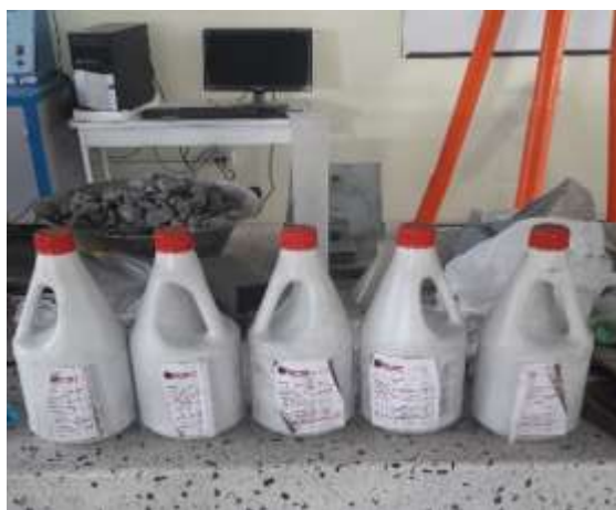
Ilustración 12 Ligante Bituminoso CRL-1Fuente. Este Estudio
