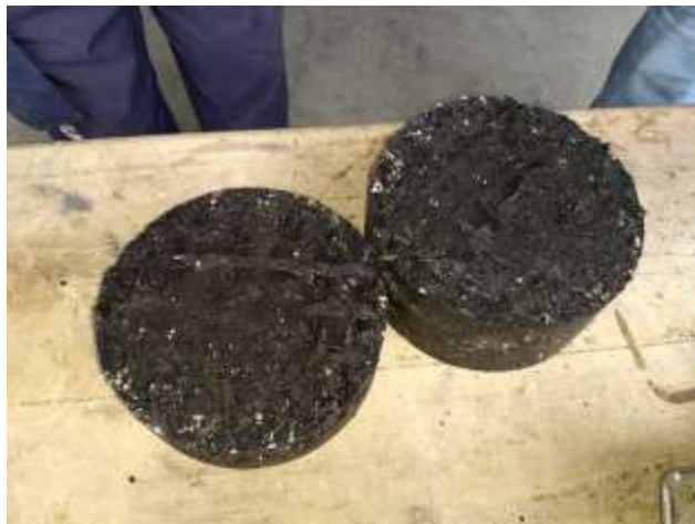
Ilustración 26 Fallamiento de cuerpos de prueba con Ensayo de Leutner, se puede observar geosintético - Fortgrid asphalt 160 Fuente Este Estudio.
