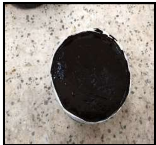
Ilustración 17 Aplicación de riego de liga CRL-1. Fuente. Este Estudio
