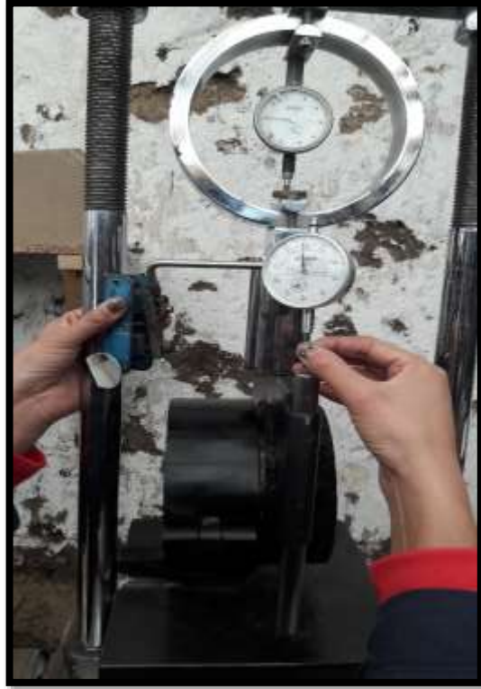
Ilustración 18 Equipo utilizado para realizar el Ensayo de Leutner en el Laboratorio Integrado de Ingeniería Civil.
