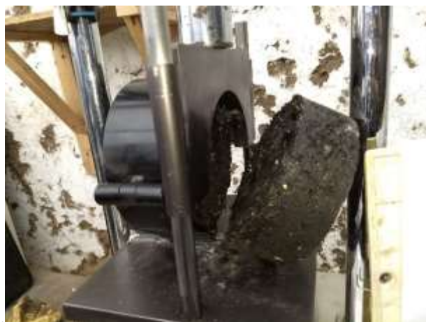
Ilustración 27 Fallamiento de cuerpos de prueba con Ensayo de Leutner, se puede observar geosintético – fiberglass grid fv 101 Fuente. Este Estudio.
