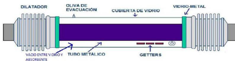
Figura 4-16.: Estructura del tubo absorbedor [46]
