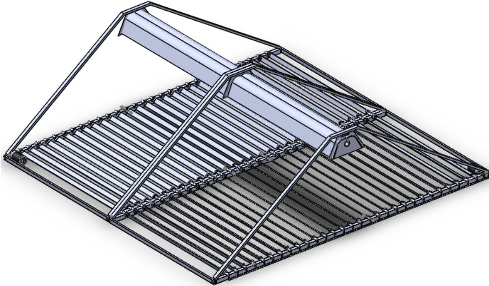
Figura 6-18.: Modelo del montaje de concentrador lineal Fresnel para la Guajira
