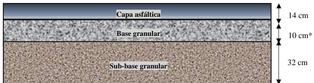
Ilustración 8 Estructura calculada con metodología AASHTO
