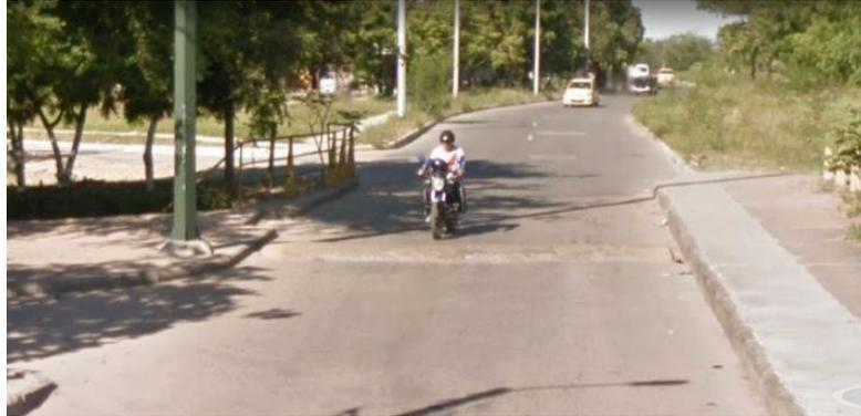
*Ilustración 21 : Ausencia de señalización en resalto Carrera 2 calle 74
