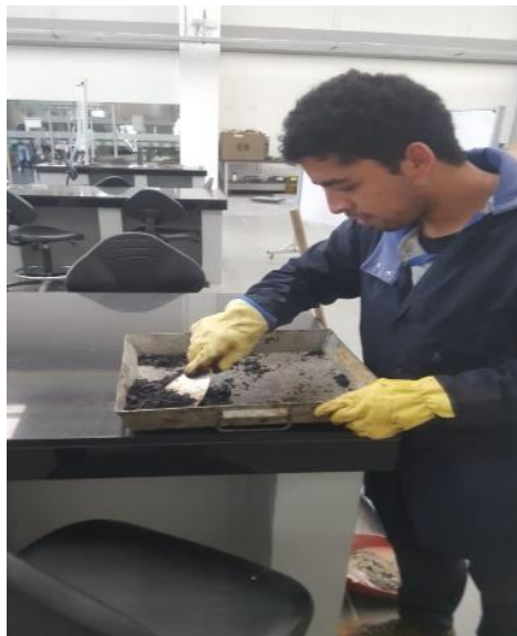
Figura 8. Mezcla de muestra de MDC-19 y microfibras en UMNG - CAMPUS
