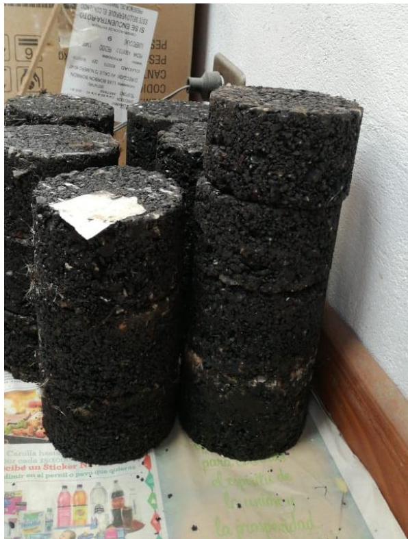
Figura 11. Briquetas Marshall con adición de microfibras SIKA
