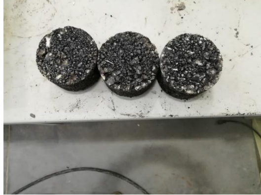
Figura 10. Briquetas Marshall sin adición de microfibras SIKA
