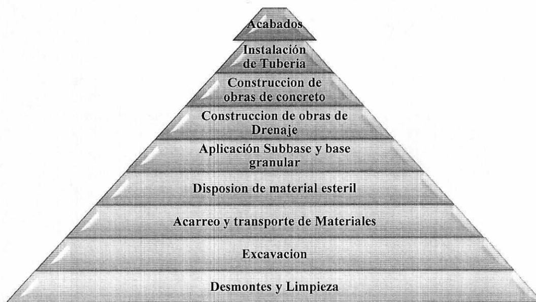
Figura 10. Fase de Construcción
