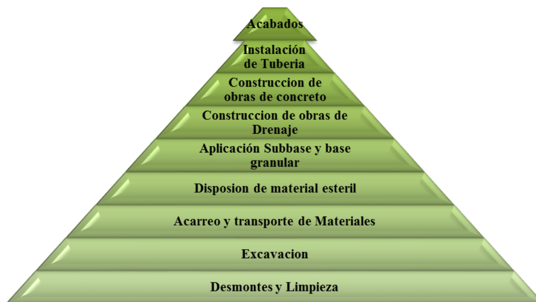
Figura 10. Fase de Construcción
