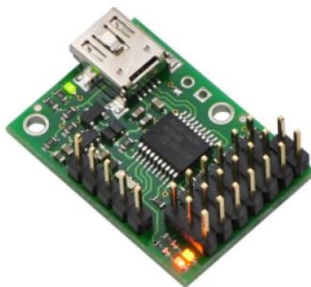
Figura 5-6 Especificaciones del Driver Micro Maestro Pololu 6 canales
