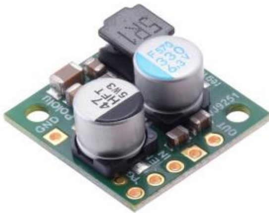
Figura 5-7 Especificaciones del Regulador D24V22F5 Pololu
