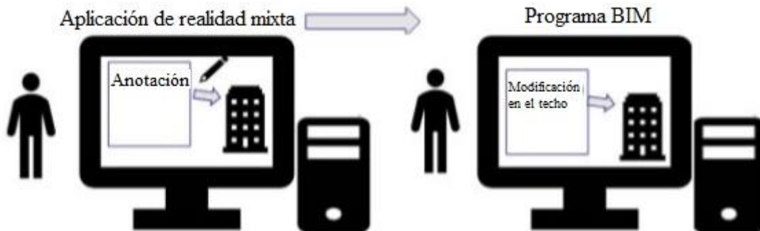
Figura 7. Nuevo enfoque en la supervisión de una obra en construcción. Fuente: Raimbaud et al. (2019).
