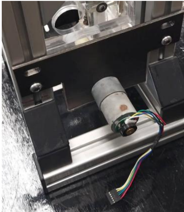
Figura 29. Motor DC con encoder magnético sistema actual. Fuente propia
