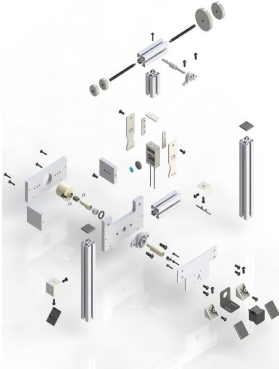
Figura 42. Renderizado del modelo explosionado del sistema para ensayos de micro abrasión. Fuente propia
