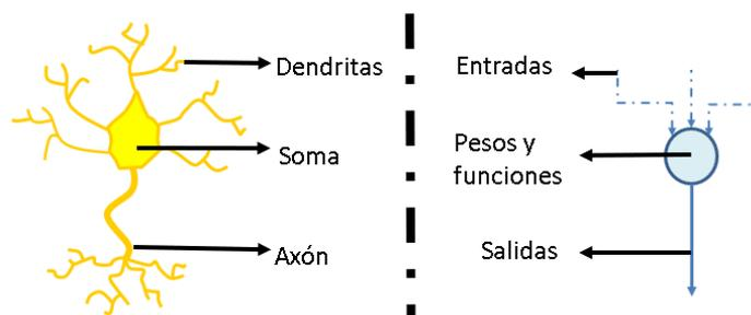
Figura 12. Comparación de las partes principales entre una neurona biológica (izquierda) y una artificial (derecha).
