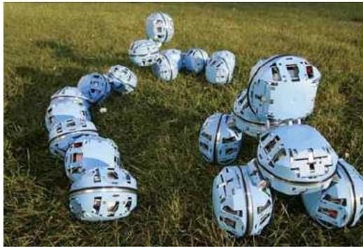
Figura 34. Robot tipo reticular – ATRON [57]
