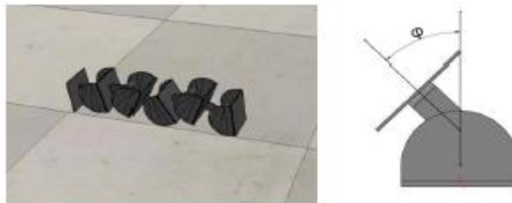
Figura 5. Configuración de pitch-pitch y módulo con ángulo de vástago. [24]
