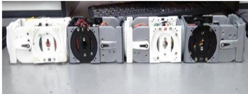
Figura 39. Configuración oruga implementada con los módulos MECABOT 3.0, implementado por las Ingenieras Lancheras y Sanabria [62]
