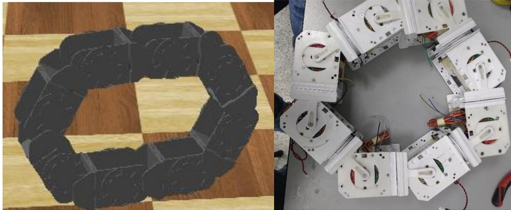
Figura 40. Diseño configuración tipo rueda MECABOT 4, por el Ingeniero Miño [63]
