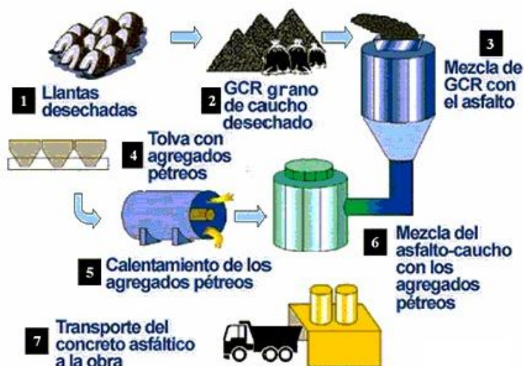
Figura 4. Proceso de aplicación por vía húmeda,.
