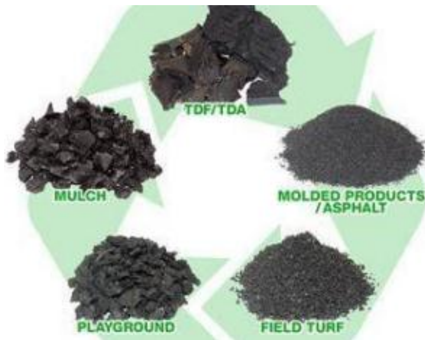
Figura 2. Características de trituración GCR
