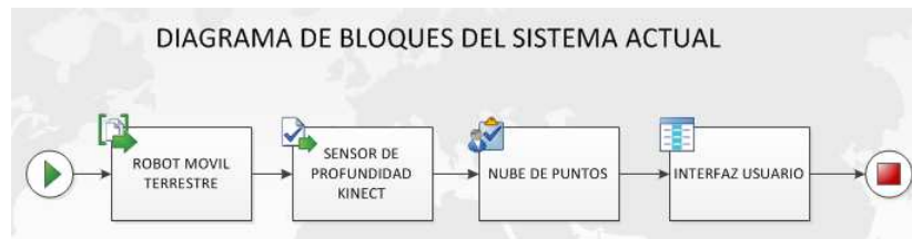
Figura 3.1: Diagrama de bloques del sistema actual
