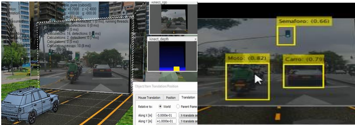
Figura 76 velocidad-distancia a partir de la detección de motos, autos y semáforo en verde
