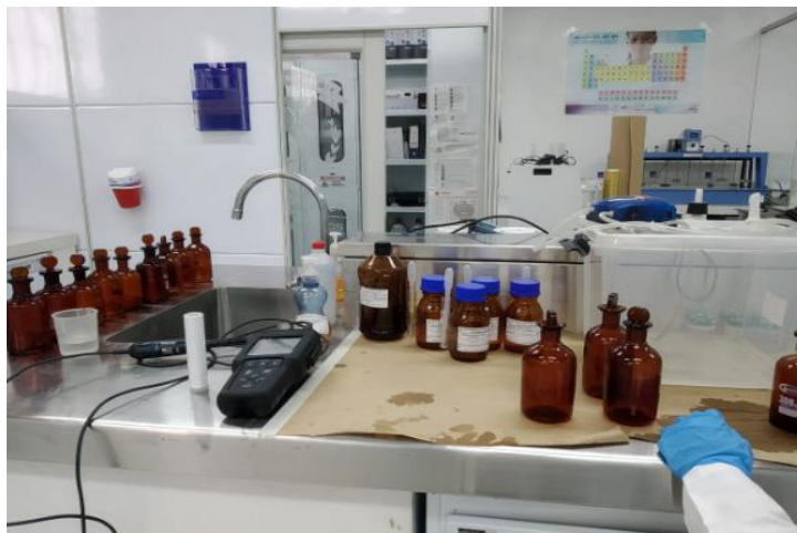
Fotografía 12. Medición de oxígeno disuelto inicial de las muestras diluidas, fuente propia.
