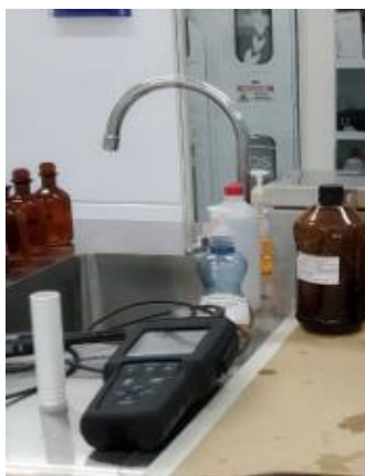
Fotografía 10. Medición de OD de las muestras con el oxímetro, Fuente propia
