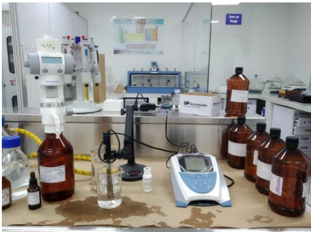
Fotografía 11. Ajustes de pH con ácido sulfúrico, fuente propia.
