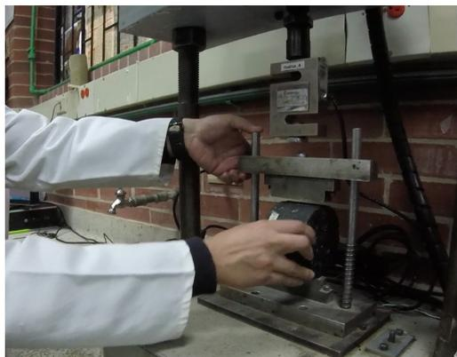
En la foto se puede observar la probeta en forma cilíndrica ubicada en medio de las dos placas metálicas que generarán la compresión. También es posible ver el cilindro electromagnético con la celda de carga en forma de S.
