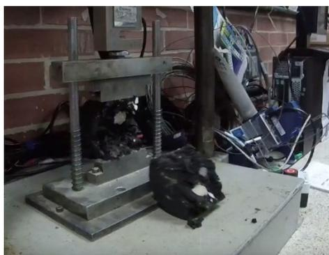
En la foto se puede ver la probeta colapsada debido a la presión mecánica recibida. Se observa que un fragmento considerable queda entre las platinas metálicas, mientras que una fracción grande y otras más pequeñas caen a la mesa donde se realiza la prueba.
