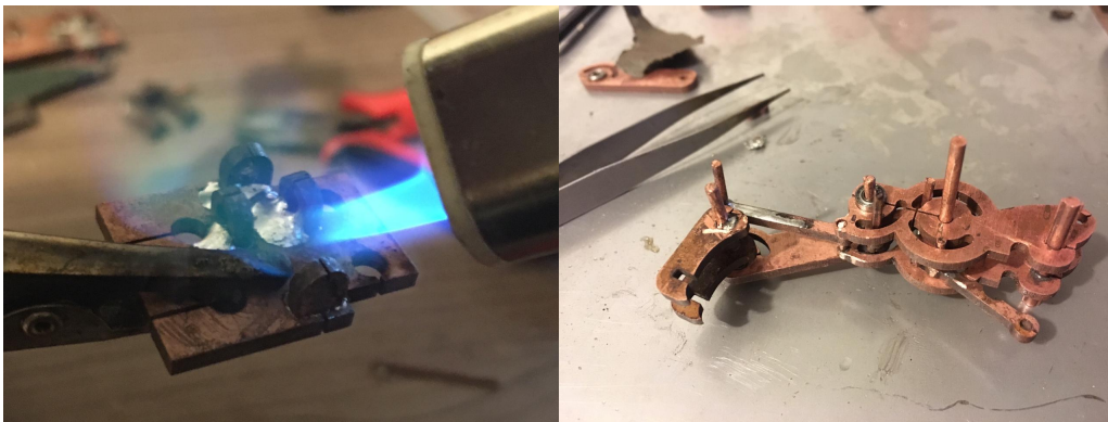
Figura 4.44: Soldadura, Base Gatillos y unión de los dedos.
