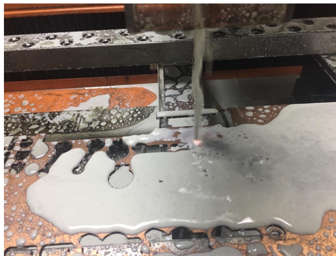
Figura 4.42: Corte electroerosionadora por corte de hilo.
