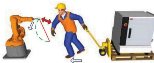
**Figura 5 Evasión de obstáculos modificando la velocidad deseada en el gripper (Mohammed et al., 2017).**
