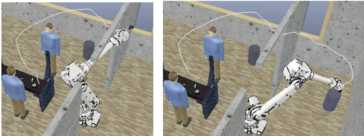
**Figura 43 Planeación de trayectoria calculada para depositar objeto clasificado como “Tim310”.**
