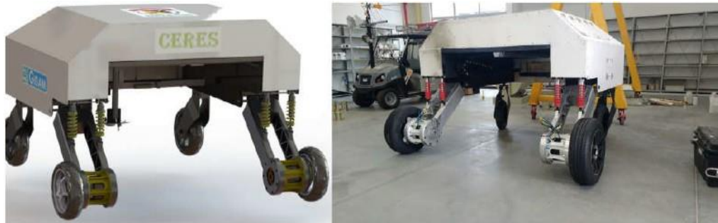
Figura 1. Ceres-AgroBot desarrollado por GIDAM (Diseño CAD y construcción)
