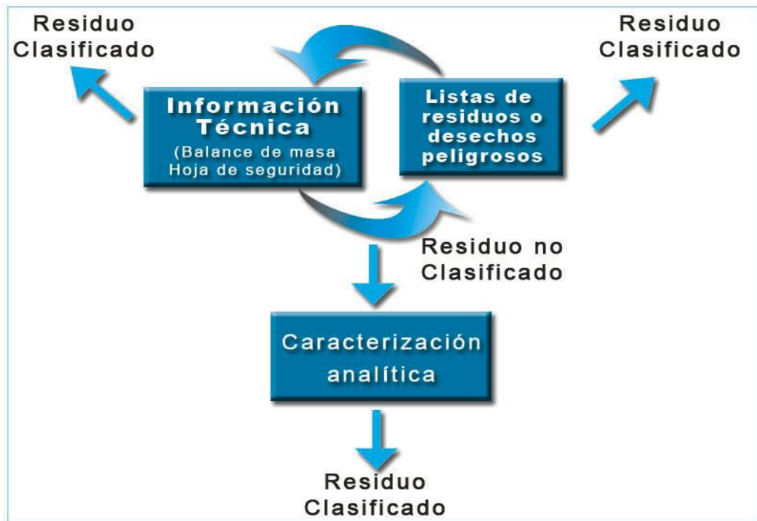
Figura 5. Esquematización de las herramientas útiles en la identificación y clasificación de los RESPEL-Químicos
