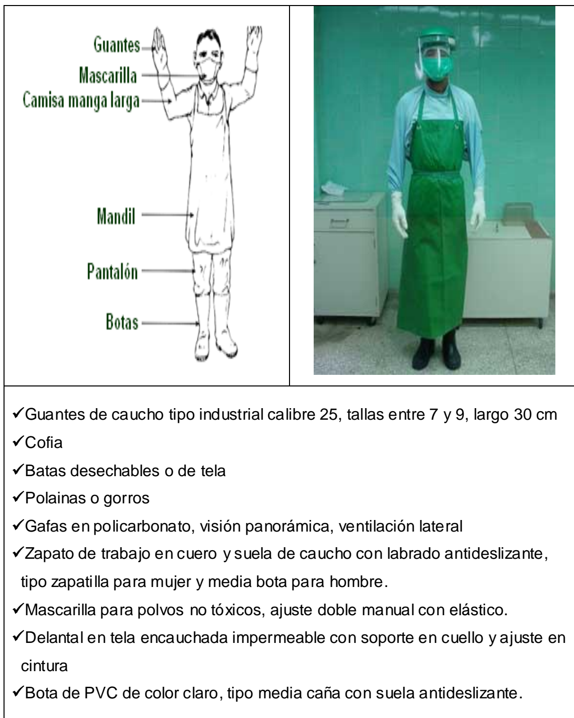
Figura 11. Elementos de protección personal para los usuarios de laboratorio o personal de limpieza, que entra en contacto con los RESPEL-Químicos
