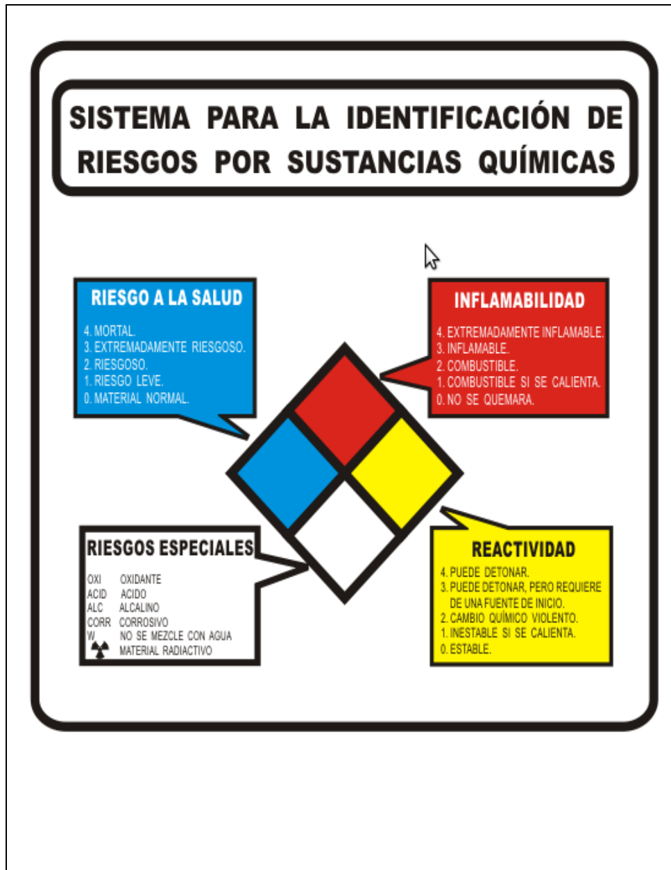
Figura 9. Sistema de clasificación y rotulado de sustancias químicas de la NFPA (National Fire Protection Association)
