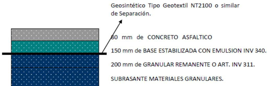
*Figura 16.* La figura muestra el diseño de pavimento de la estructura reciclada para el mejoramiento de la vía Villeta – Útica según la revisión de los Estudios y diseños adelantada por el Contratista en el año 2020. (*Consortio Vías Quebradanegra , 2020*)
