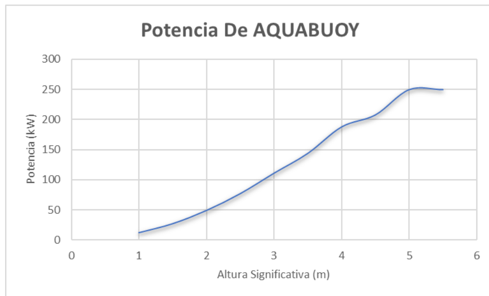
Figura 20 Energía del absorbedor puntual AQUABUOY Fuente: Propia
