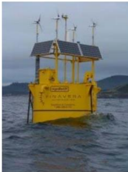
Figura 19 Dispositivo AQUABUOY De Finavera Fuente FINEVERA
