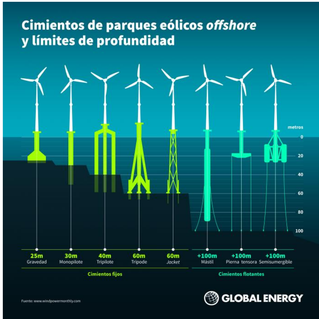
Figura 12 Cimentaciones de turbinas eólicas
