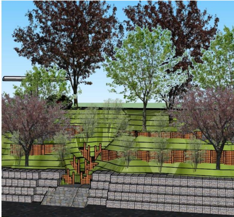
*Ilustración 29 Modelo de estabilidad con obras de bioingeniería.*
